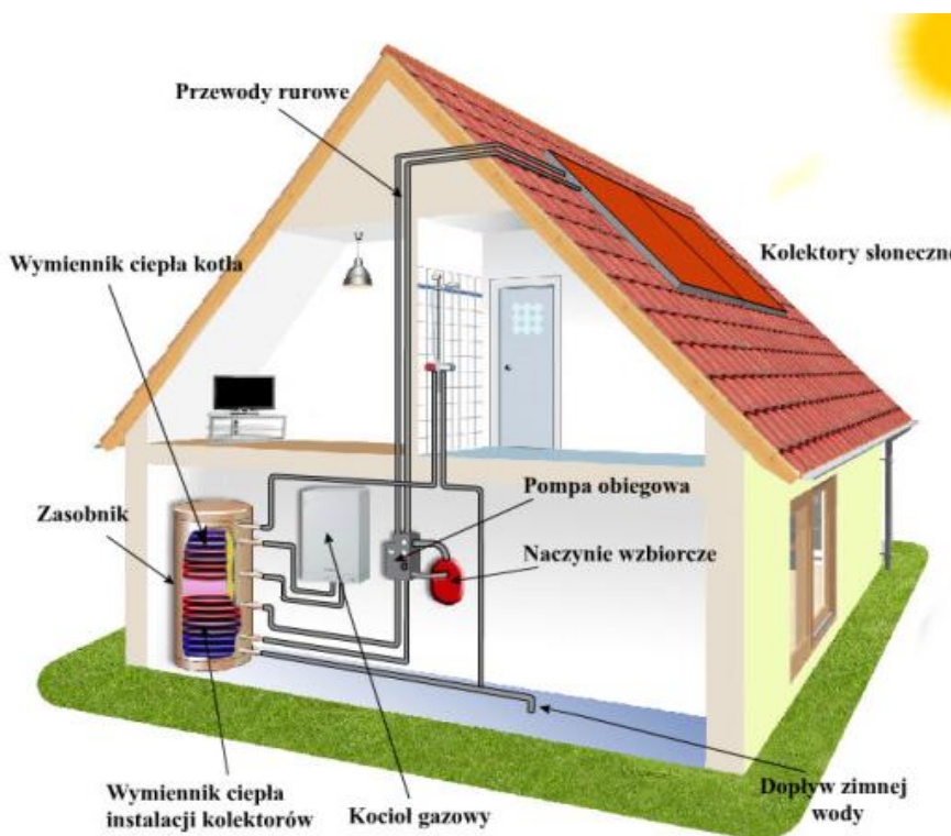
Ryc. 11. Schemat instalacji kolektorów słonecznych w domu jednorodzinnym
